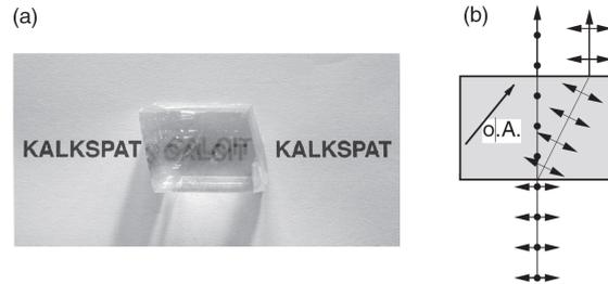
Abb. 4: Doppelbrechung an einem Calcitkristall [8]
