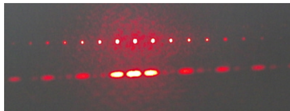
Abb. 4: oben: Beugungsgitter mit 100 Spalten, unten: Doppelspalt [4]
